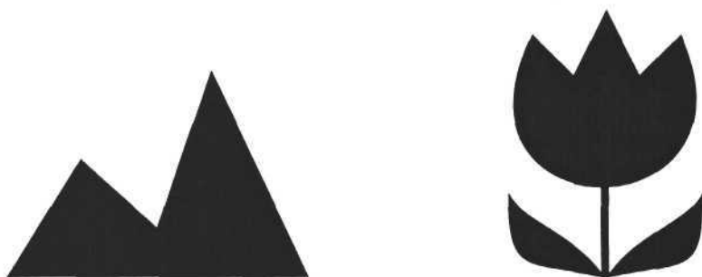
Рис. 4.29. Пиктограммы, которыми обозначается переключение ступеней автофокуса: «бесконечность» и «макросъемка»
